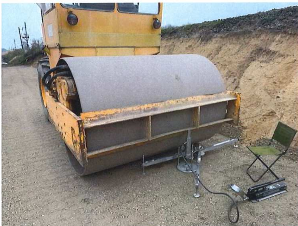
Budovanie zemného telesa pri koľaji č.2 v km 74,130-74,230 – statická zať. skúška
